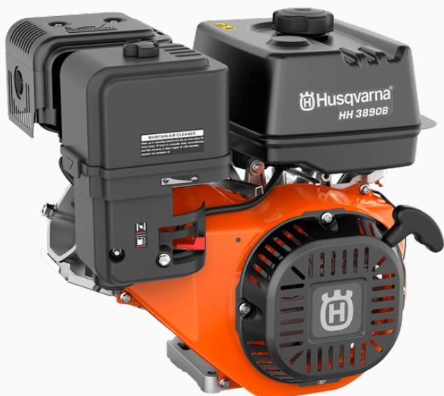
Motor Husqvarna de 13HP (Náutico) robusto y duradero. Escape: Equipado con silenciador para un funcionamiento con menor ruido. Filtro de aire: Filtro de espuma simple para un mayor rendimiento. Carburador: Flotador con vaso de sedimentos para un mejor mantenimiento. Los ejes de salida estándar están diseñados para adaptarse fácilmente a los equipos existentes.
