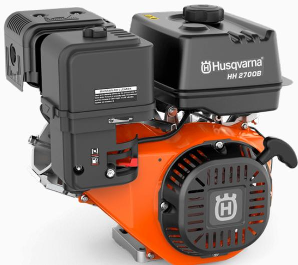
El Motor Horizontal Husqvarna HH 2700B (Náutico) es robusto y duradero. Los ejes de salida estándar están diseñados para adaptarse fácilmente a los equipos existentes. Escape: Equipado con silenciador para un funcionamiento con menor ruido. Filtro de aire: Filtro de espuma simple para un mayor rendimiento. Carburador: Flotador con vaso de sedimentos para un mejor mantenimiento.
