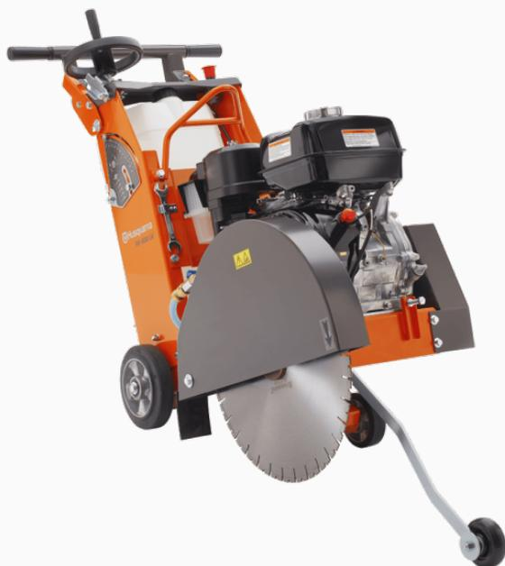
La cortadora de piso FS 400 LV, es la más liviana, eficiente y confiable herramienta de corte a empuje con motor Husqvarna HH 389MPC. Para discos de 14" a 18", es perfecta para cortes de junta o demolición de pavimentos. El asa ajustable garantiza una posición de trabajo ergonómica. La perfecta distribución del peso proporciona una excelente estabilidad durante el corte.
