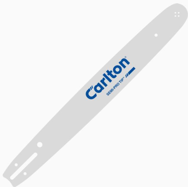
Espada Carlton SEMIPRO: Rendimiento confiable para trabajos exigentes. La espada Carlton SEMIPRO de 40 cm combina precisión y durabilidad en un diseño robusto. Con paso ,325" bajo perfil y un calibre de 1.5 mm, es ideal para motosierras universales. Su punta Semi-Pro reduce el retroceso y mejora el control, brindando seguridad y eficiencia en cada corte.
