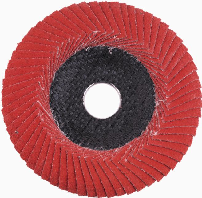
Diseño especial con láminas redondeadas en el extremo, ideal para el tratamiento eficiente de costuras de soldadura y superficies. Alta potencia abrasiva y larga vida útil gracias al grano cerámico. Permite un rectificado refrigerado en materiales con baja conductividad térmica. Apto para acero, acero inoxidable, aceros altamente aleados, aleaciones de titanio, níquel, cromo, latón y bronce. Ofrece un acabado uniforme, rectificado cómodo y con mínimas vibraciones.
