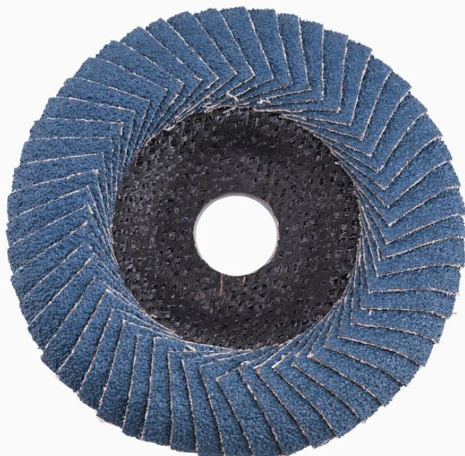
Disco abrasivo de láminas especialmente diseñado con extremos redondeados, ideal para trabajos exigentes en acero y acero inoxidable. Su abrasivo de corindón de circonio garantiza una excelente potencia de corte y una larga vida útil. Gracias a su diseño, permite un tratamiento rápido y eficiente de costuras de soldadura, así como el rectificado de superficies, ofreciendo un acabado uniforme y un trabajo cómodo con mínimas vibraciones.
