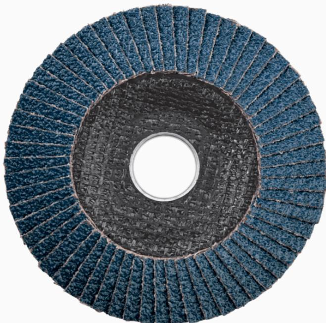
Disco flap biselado, ideal para rectificado basto y medio en acero, acero inoxidable, hierro fundido y chapa. Su grano cerámico ofrece alta potencia abrasiva constante y rectificado refrigerado, incluso en materiales difíciles. Especialmente indicado para Inox y trabajos exigentes. Proporciona un acabado uniforme, con mínimas vibraciones y un ángulo de ataque óptimo de 79°.
