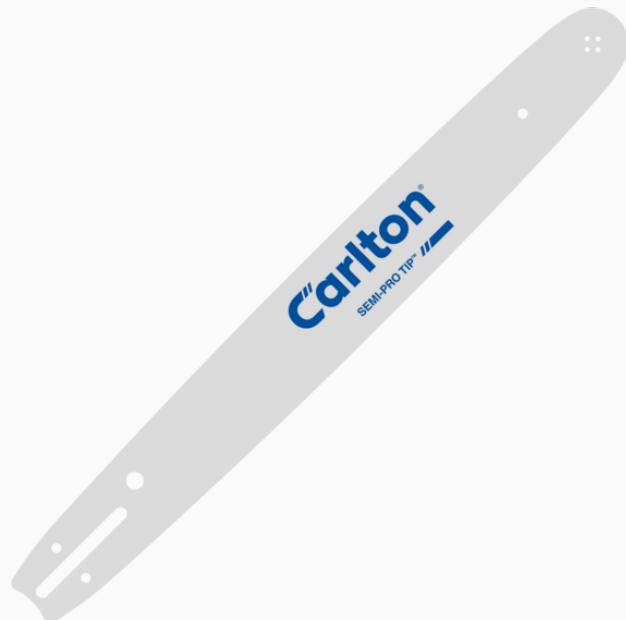
Espada de la línea SEMIPRO de Carlton, diseñada para motosierras de uso frecuente y semi-profesional. Con 40 cm de largo, paso de cadena 3/8 Low Profile y calibre de 1,3 mm, ofrece un excelente equilibrio entre rendimiento, precisión y durabilidad en trabajos de poda y corte de madera.
