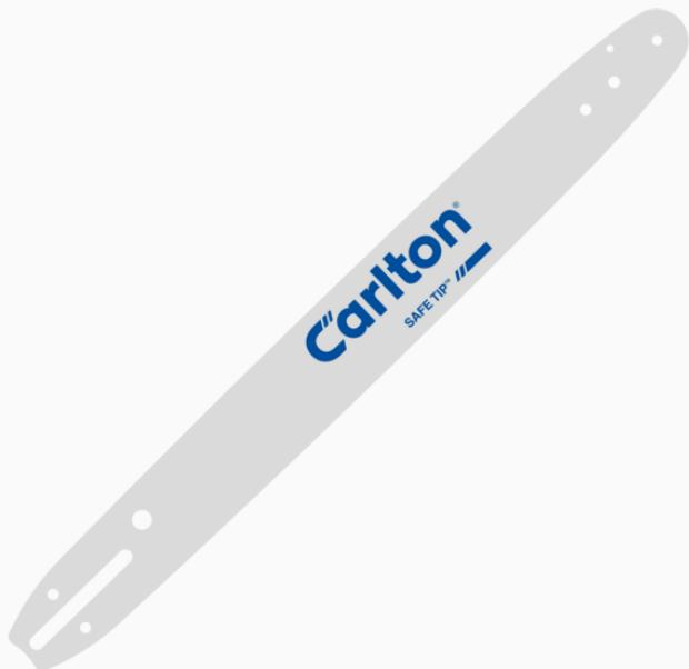
Espada de la línea SAFETIP de Carlton, diseñada para brindar mayor seguridad en el uso de motosierras. Con 40 cm de largo, paso de cadena 3/8 Low Profile y calibre de 1,3 mm, reduce el riesgo de retroceso sin sacrificar rendimiento ni durabilidad.
