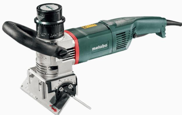
Potente biseladora, para preparar costuras de soldadura o realizar biseles sobre plano en tubos de Ø 75 mm en adelante. Realiza ángulos de bisel de 0-90°, para biseles de hasta 15 mm de altura. Placas guías de metal para realizar biselado controlado.
