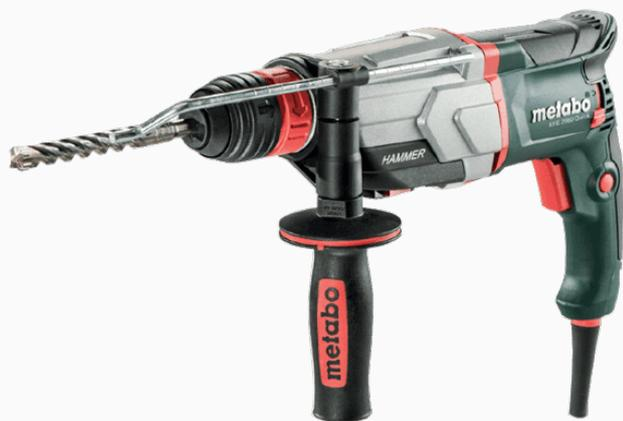
Martillo combinado eléctrico Metabo KHE 2860 Quick 3 funciones, para perforar con percusión, perforar sin golpe y cincelar. Con sistema Quick de Metabo cambio rápido entre mandril de martillo SDS-Plus y porta brocas de sujeción rápida para perforar en madera y metal.
