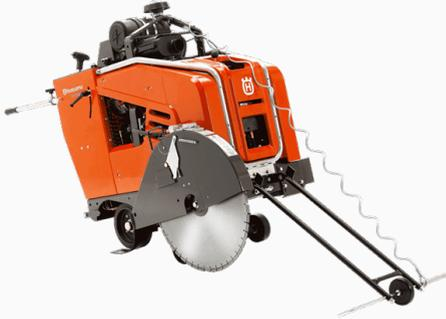
La poderosa FS4800D es una cortadora de piso diésel autopropulsada de 48 HP y 3 velocidades, lo que permite hacer cortes con discos desde 14" a 36", y una profundidad de corte máxima de 381 mm. Es perfecta para trabajos de medianas dimensiones en aeropuertos y autopistas, así como trabajos de mantenimiento y pequeños trabajos que requieran alta productividad.
