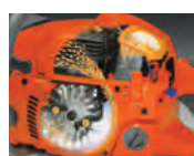
Sistema de inyección de aire
