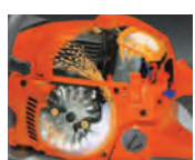
Sistema de inyección de aire
