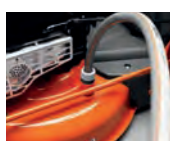
Puerto de lavado, para limpieza de plataforma
