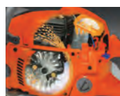
Sistema de inyección de aire
