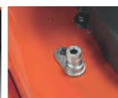
Puerto de lavado, para limpieza de plataforma
