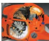
Sistema de inyección de aire
