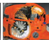
Sistema de inyección de aire
