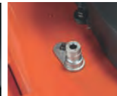
Puerto de lavado, para limpieza de plataforma
