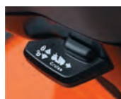
Control crucero para velocidad estable
