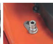
Puerto de lavado, para limpieza de plataforma
