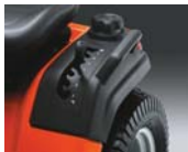
Regulación de altura en guardabarros
