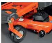
Plataforma de corte de acero reforzado
