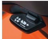
Control crucero para velocidad estable
