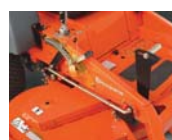
Subida de plataforma asistida por pedal
