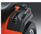
Regulación de altura en guardabarros
