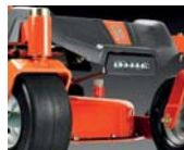
Paragolpe con luces Led integradas
