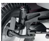
Eje delantero de hierro fundido
