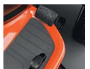
Transmisión hidrostática accionada por pedal
