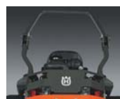
Sistema de protección antivuelco (ROPS)
