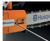
Tensador de cadena montado de costado
