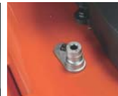
Puerto de lavado, para limpieza de plataforma
