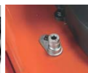
Puerto de lavado, para limpieza de plataforma
