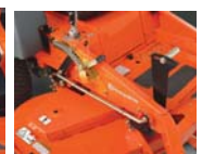
Subida de plataforma asistida por pedal
