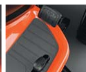
Transmisión hidrostática accionada por pedal
